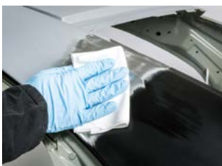
Flächen mit TEROSON VR 10 reinigen und vorbereiten
