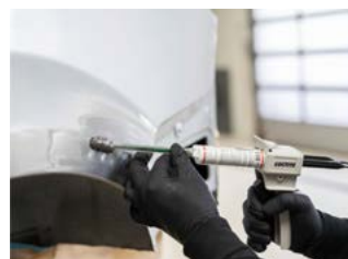
Auftragen von TEROSON EP 5010 TR/TEROSON EP 5020 TR
