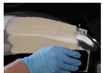
Auftragen von Spachtel TEROSON UP 210
