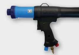
Sininen venttiili suljettu. Punaista venttiiliä avataan, kunnes mäntä koskettaa patruunaa ja materiaali virtaa ulos.
