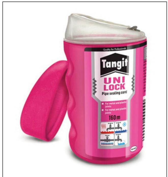
Raspon primjene uključuje cijevi za dovod hladne i tople vode (do 130 °C) kao i plinske cijevi. Uže je posebno prikladno za navojne spojeve koji zahtijevaju neposrednu čvrstoću nakon sastavljanja i možda će trebati male prilagodbe prije upotrebe. Metalni navoj max. 4". Plastični navoj max. 1½".
