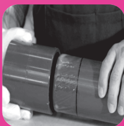
Geschikt voor het verlijmen van leidingen, moffen en verbindingstukken in hard PVC
