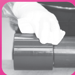
Le nettoyage et l'activation des surfaces collées sont absolument essentiels afin d'assurer un collage fiable.
