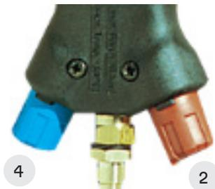
Pre početka rada, moraju da se podese regulator medijuma koji se primenjuje i regulator za premazivanje. Ako je potrebno, obavlja se test na pogodnoj površini.
