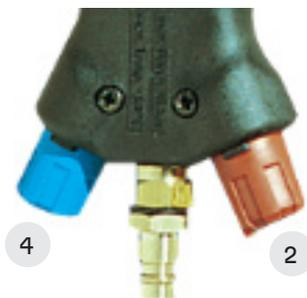
Prima di iniziare la lavorazione, è necessario impostare il regolatore per il fluido da lavorare e il regolatore per il lavoro di rivestimento. Se necessario, procedere con una prova su una superficie adeguata.
