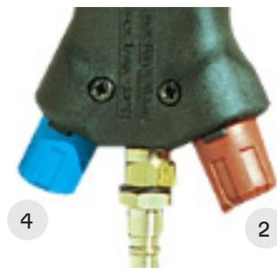
Antes de iniciar la aplicación, deben ajustarse perfectamente el regulador para flujo de producto y el del aire para la pulverización del material. Si es necesario, efectuar antes una prueba en una superficie adecuada.
