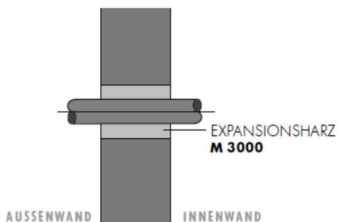
Zur Befestigung und dauerhaften Abdichtung gegen drückendes Wasser gemäß DIN 18533 W2.1-E
