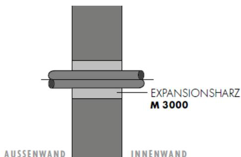
Zur Befestigung und dauerhaften Abdichtung gegen drückendes Wasser gemäß DIN 18533 W2.1-E
