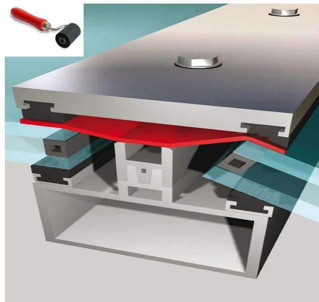
Die Folie deshalb kräftig, insbesondere an Überlappungen und Rändern, mit der Teroson Hartgummirolle anrollen. Überlappende Folienstöße mit ca. 50 mm Breite übereinander kleben. Eine zusätzliche mechanische Befestigung ist grundsätzlich nicht erforderlich.
