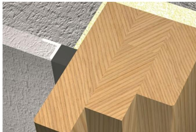
Jede Seite sollte einzeln beklebt werden. In den Ecken das Dichtband stoßen. Teroson PT ECO MAX 600 Längen können problemlos aneinandergesetzt werden, sofern die Enden sorgfältig abgeschnitten wurden. Die Stoßstellen müssen genau aufeinanderpassen. Die beiden Bandenden müssen leicht gestoßen werden.
