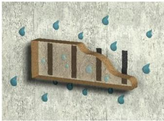
Strangweiser Auftrag (senkrecht): Mit diesem Auftrag kann die zirkulierende Luftfeuchtigkeit die Stränge gut aushärten und nach Erreichen der Endfestigkeit kann Regen, Schnee, Feuchtigkeit perfekt abgeleitet werden. Mit einem geeigneten Zahnpachtel kann der Klebstoff auch aufgezogen werden.
