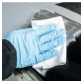
Puhastamine ja eeltöötlus tootega TEROSON VR 10
