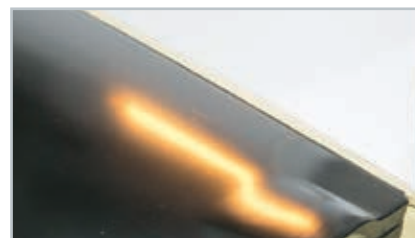
Kiire tahkumine lisakuumutusega
