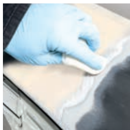
BONDERITE M-NT 1455-W pealekandmine, ainult halja metalli töötlemiseks. Hoida märjana 2 minuti vältel
