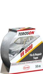
Nastro telato per riparare, rinforzare, fissare, sigillare e proteggere. Eccellente adesione a tutti i tipi di superfici asciutte e senza contaminazione da olio o polvere. Adatto anche per applicazioni all'esterno. Può essere utilizzato per riparazioni di emergenza di tubazioni, resiste a una pressione fino a 4 bar.
