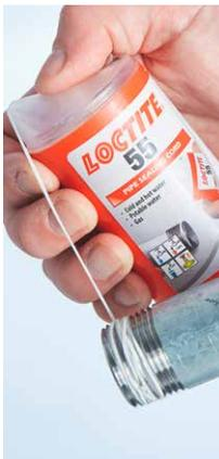
È formulato per il bloccaggio e la sigillatura di raccordi e tubazioni in metallo e plastica. E' la scelta ideale per una sigillatura rapida, facile e affidabile. Certificato per: acqua potabile secondo il DM 174/2004, acqua fredda e calda (130°C), gas della 1a, 2a e 3a famiglia, incluso GPL in forma gassosa, ossigeno gassoso 60°C 20 bar. Collaudato su tubi da 4".
