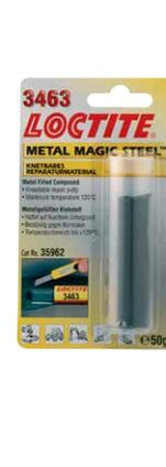
Stick impastabile caricato con acciaio. Aderisce sulle superfici umide e polimerizza in acqua. Ideale per la sigillatura d'emergenza di tubi e serbatoi che perdono (es. piombo, rame o plastica). Livella saldature, ripara piccole crepe e riempie fori troppo larghi. Tempo di lavoro 3 minuti, indurisce in 10 minuti. Resiste alla corrosione ed agli agenti chimici. Può essere forato, carteggiato e verniciato.
