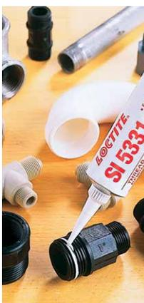
Raccomandato per raccordi filettati in plastica o plastica/metallo utilizzati per tubazioni di acqua calda o fredda, ad es. impianti di approvvigionamento idrico in plastica ad uso industriale ed agricolo o impianti di drenaggio. Ha ottenuto le approvazioni DVGW (NG-51 AR 0618) e KTW per gas e acqua potabile. Testato in conformità alla norma UNI EN 751-1. Approvazione WRC per l'uso con acqua potabile fino a 85°C.
