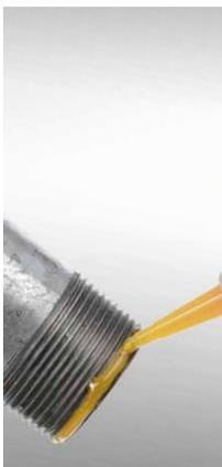
È formulato per il bloccaggio e la sigillatura di raccordi e tubazioni in metallo. Garantisce una sigillatura istantanea a bassa pressione di tutti i raccordi NPT e le tubazioni in metallo anche a basse temperature. Ideale per applicazioni facili anche in verticale. Ha un'eccellente resistenza chimica e termica. Dimensione massima del tubo: 3".
