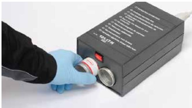
Il riscaldamento del prodotto facilita l'applicazione a bassa pressione e permette un cordolo molto più liscio e uniforme. Riscalda le cartucce nel fornello (max. 60°C).
