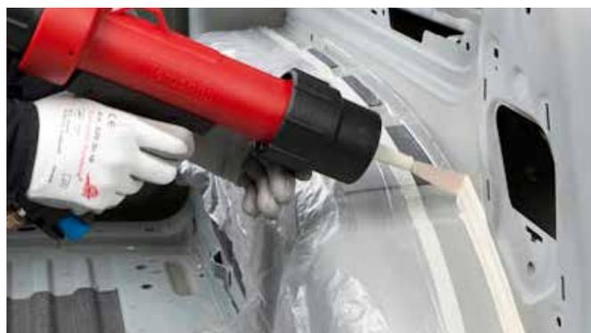
Applicare il sigillante con il beccuccio a contatto con la superficie da trattare. La pressione di applicazione sulla pistola TEROSON POWERLINE II deve essere tra 5 e 7 bar. Per applicare il sigillante ad una distanza di 5-10 cm sulla pistola TEROSON POWERLINE la pressione deve essere regolata a 10 - 15 bar.
