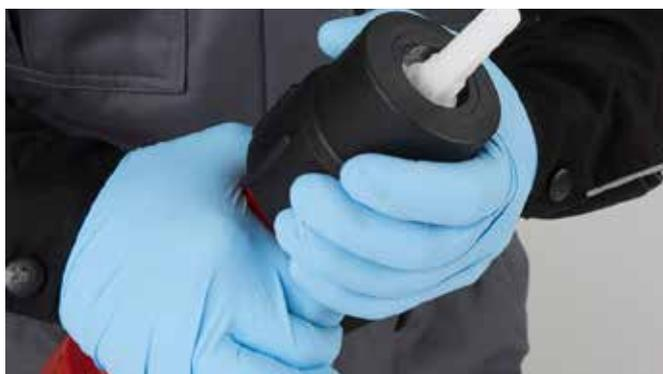
Premere la punta filettata della cartuccia sull'apricartucce per rompere il sigillo e permettere l'uscita del prodotto. Avvitare con forza il beccuccio. Inserire la cartuccia e regolare il beccuccio in posizione di funzionamento. Anche per applicazioni in verticale. Per guidarti durante l'applicazione usa le alette sul beccuccio.
