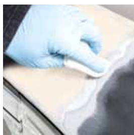
Nanošenje BONDERITE M-NT 1455 W isključivo na metalnim površinama. Držati vlažnu površinu 2 minuta.
