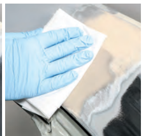
Sredstvo izhlapeva 5 min. preden začnemo z barvanjem
