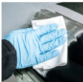
Čiščenje in predpriprava z izdelkom TEROSON VR 20
