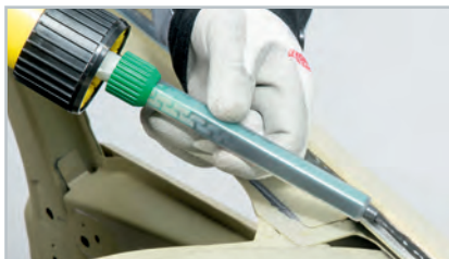
Enostaven nanos s statičnim mešalnikom
