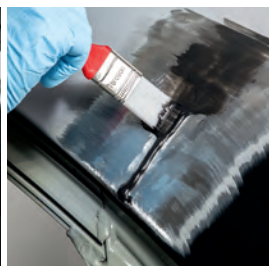
Difuzijska zaščitna plast z izdelkom TEROSON EP 5055
