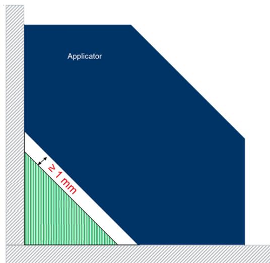
2. Aplicar una capa uniforme mientras se desliza a lo largo de toda la superficie, asegurando que la silicona entra en contacto con la junta a recubrir. En caso de juntas verticales se recomienda aplicar el producto desde abajo hasta arriba.
