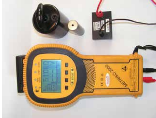
Nagy pontosságú, memóriás műszer levezetési ellenállás mérésére
