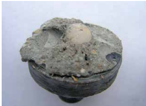
Tapadó-húzó szilárdság mérés megfelelő szakadási képére példa
