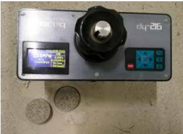
Az automata, beállítható húzási sebességű műszer nagypontosságú, memóriás műszer kijelzője minden lényeges adatot tartalmaz
