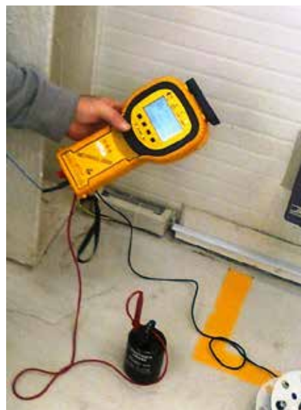
Nagy pontosságú digitális, memóriás vezetési ellenállást mérő műszer
