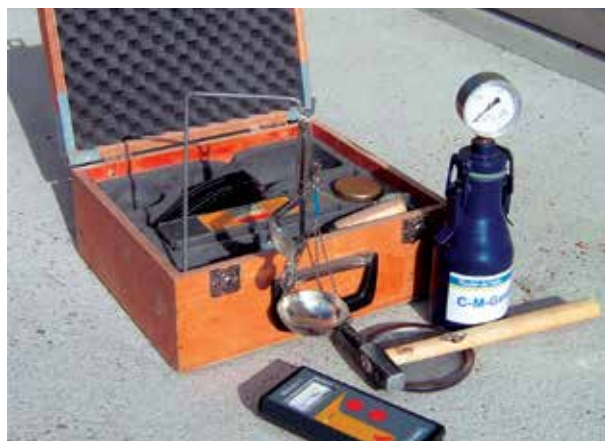
CM karbid kapszulás nedvességtartalom mérő berendezés
