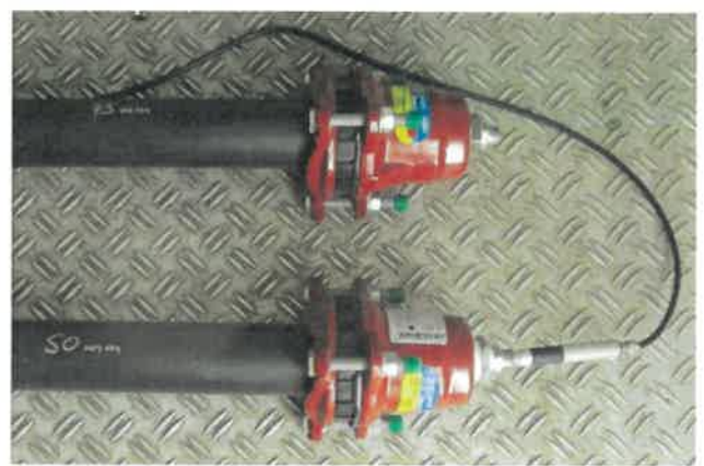
Abbildung 3: Schnüffelsonde Lecksucher druckabgewandte Seite
