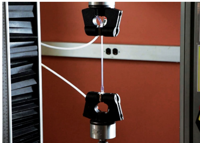
FIGURA 5. Prueba de cortadura con LOCTITE® AA 3951 que dio lugar al fallo del TPU.
