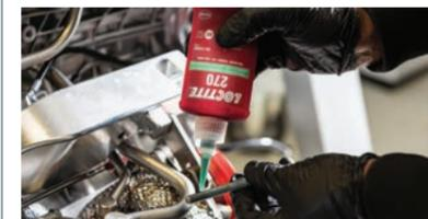
Mit normalen Handwerkzeugen nur sehr schwer demontierbar, eventuelles Erwärmen erforderlich. Für Schrauben in Anlagen, die nicht regelmäßig demontiert werden müssen – Schwermaschinen, Motor- und Pumpenlager, Stiftschrauben; für Gewinde bis M50.
