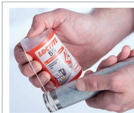
LOCTITE 55 wird für das Sichern und Dichten von Rohrgewinden und Anschlussstücken aus Metall und Kunststoff verwendet. Das Produkt erfordert keine Wartezeit für die Aushärtung und erzielt sofortige Dichtwirkung gegen vollen Druck. Das Produkt ist für Gas und Trinkwasser freigegeben und nach NSF/ANSI Standard 61 zertifiziert.
