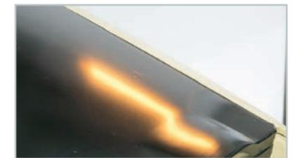
Beschleunigte Aushärtung durch Wärme möglich
