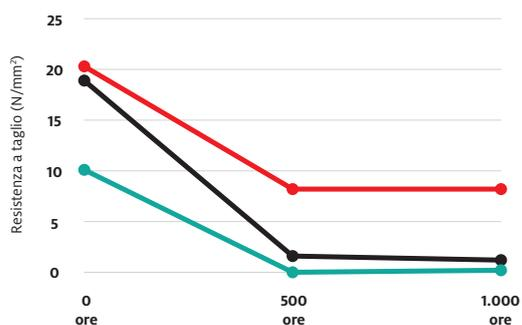
— LOCTITE 402      — CA insensibile alla superficie      — CA Alta temperatura      - - - Dati stimati
