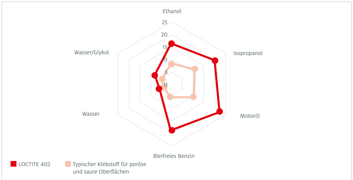
Abb. 12 Zugscherfestigkeit (N/mm 2 ) für LOCTITE 402 und einen typischen Klebstoff für poröse und saure Oberflächen auf Edelstahl nach 1.000 Stunden Alterung in verschiedenen Lösungsmitteln/Medien.
