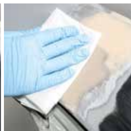
Tempo de evaporação: 5 min antes de pintar
