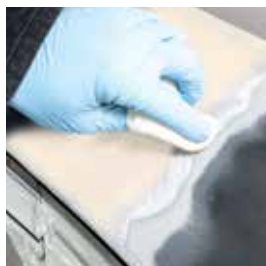
Aplicação de Bonderite M-NT 1455 W apenas sobre a superfície de metal sem tratar. Manter húmido durante 2 min
