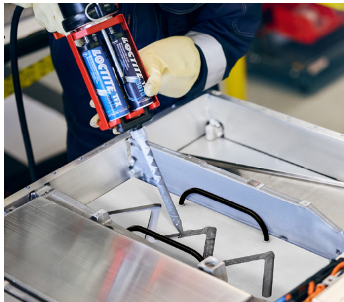
APLICACIÓN DE LA PASTA DE DISIPACIÓN TÉRMICA LOCTITE TFX 3010
