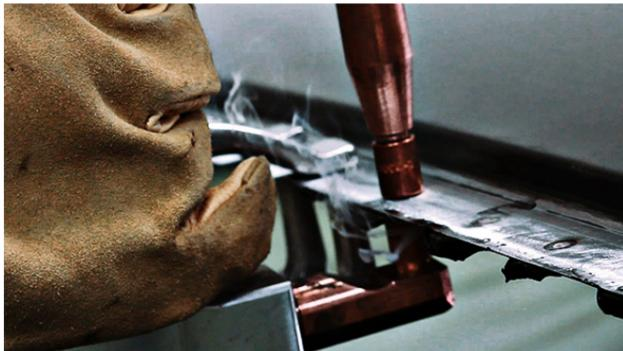
Fija el techo. Si es necesario soldar por puntos, hazlo en un tiempo máximo de 60 minutos después de la aplicación del producto.
