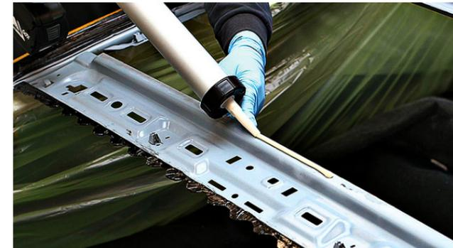
Aplica TEROSON MS 9120 SF en los refuerzos del techo como producto antivibraciones. Monta el nuevo techo dentro del tiempo abierto de los productos, aproximadamente 30 min. El producto no deja marcas o huellas en la pintura.
