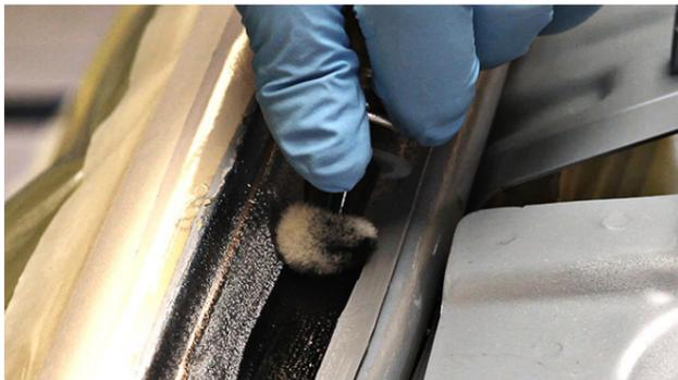
Si trabajas con metal en bruto, aplica TEROSON PU 8519 P para preparar la superficie para realizar el junco para el pegado de la luna.
