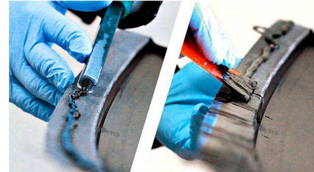
Para evitar la corrosión aplica TEROSON EP 5065 con la pistola adecuada (con una pistola telescópica) y extiende el adhesivo con una brocha o espátula hasta dejar una fina película en las superficies de metal en bruto.
