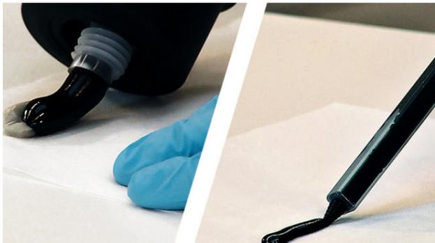
Desenrosca el anillo de cierre de TEROSON EP 5065 y extruye una pequeña cantidad de producto para asegurarte que ambos componentes fluyen de forma adecuada. Coloca la boquilla mezcladora y extruye los primeros 5 cm del adhesivo mezclado.
