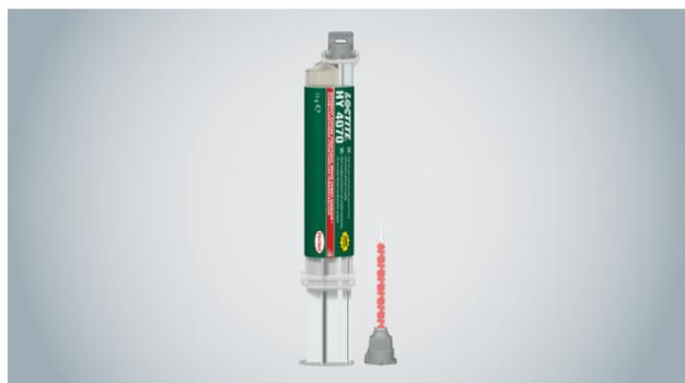
LOCTITE HY 4070 tiene un tiempo de apertura recomendado de <60 segundos. Después de ese tiempo, el producto cambia a una consistencia similar a un gel. Después, deberás cambiar la boquilla de mezcla para continuar con la aplicación del producto.
