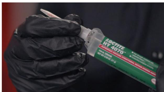
Mientras mantienes el cartucho en posición vertical, retira la tapa, coloca la boquilla mezcladora y comienza a dispensar el adhesivo hacia arriba hasta que desaparezcan todas las burbujas.
