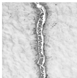
Mikropukotina ojačana vlaknima
