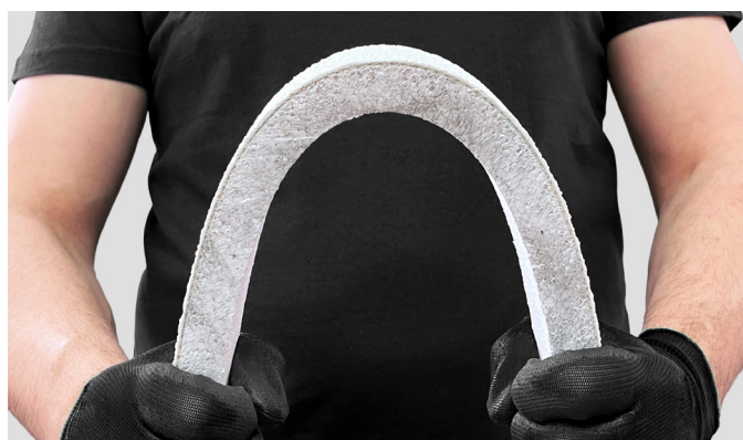
Završni sloj ojačan vlaknima sa odličnom fleksibilnošću
