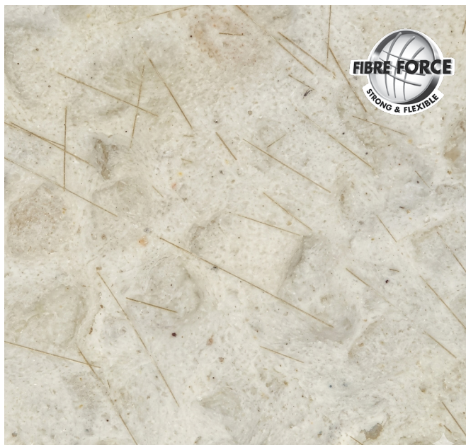
Mikroskopski prikaz vlakana unutar završnog sloja
