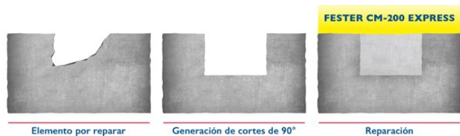
Imagen 1. Preparación de la superficie y aplicación
