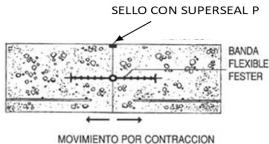
En la siguiente figura se ilustra la banda y el sellador para el caso de una junta de control tomando en cuenta que la banda evitará el flujo del agua.
