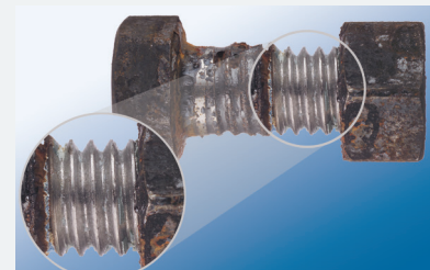
Área de acoplamiento de un perno oxidado al que SÍ se le aplicó un fijador de roscas de LOCTITE®.
