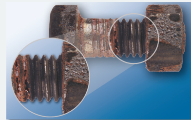
Área de acoplamiento de un perno oxidado al que NO se le aplicó un fijador de roscas de LOCTITE®.
