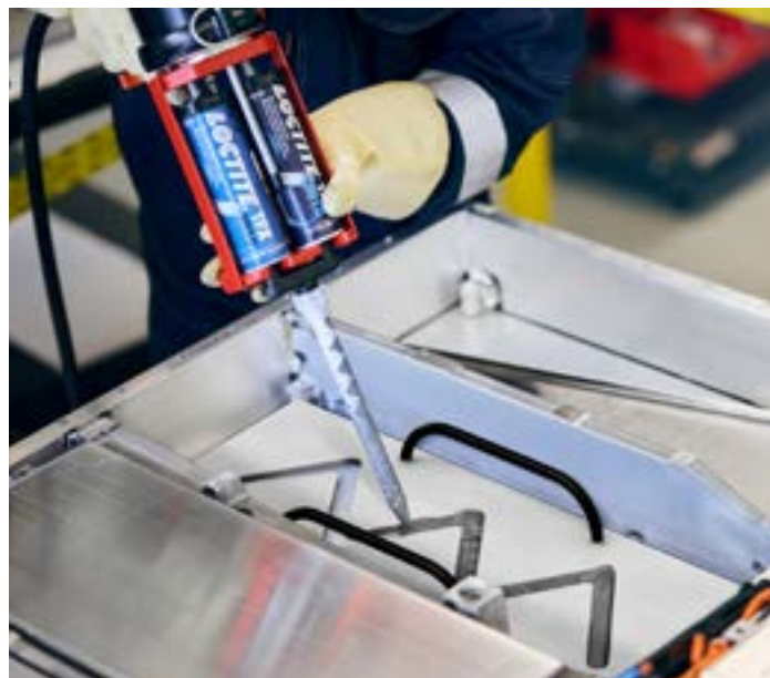
ΕΦΑΡΜΟΓΗ ΠΛΗΡΩΤΙΚΟΥ ΘΕΡΜΙΚΩΝ ΔΙΑΚΕΝΩΝ LOCTITE TFX 3010
