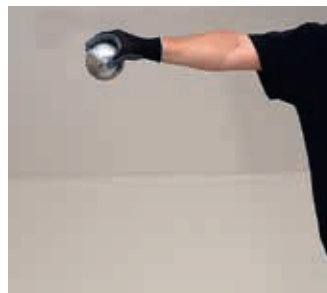
Smūgio į sistemos paviršių bandymas.
