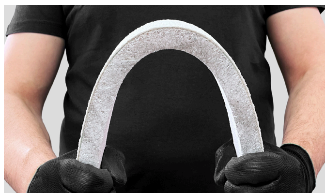
Завршен слој зајакнат со влакна со одлична флексибилност.
