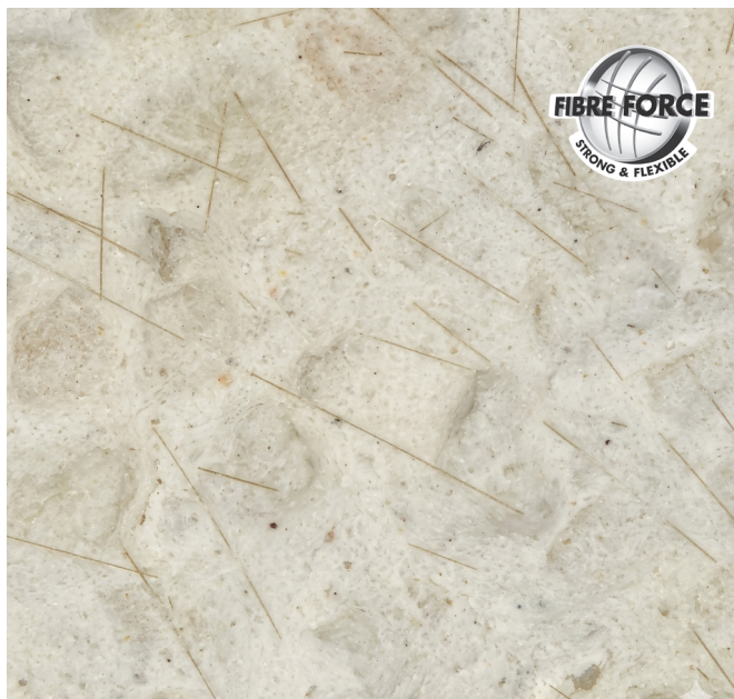
Paraqitje mikroskopike e fibrave brenda shtresës përfundimtare.
