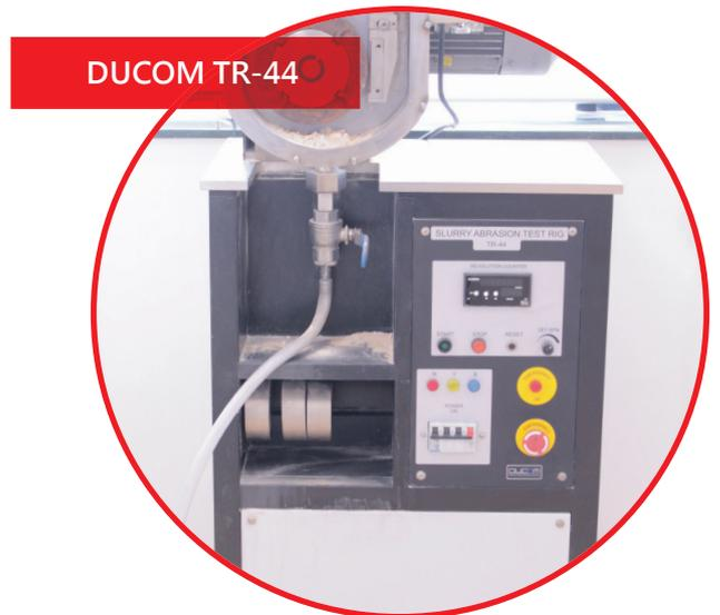
2.2 测试方法和参数 (续) Miller 测试由 DUCOM TR-4 Miller 和 SAR 数试验机依据 ASTM G7 -01 标准进行。
