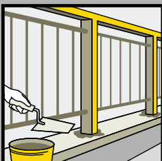
Postavljanje rukohvata na ogradi
