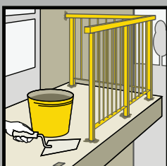
Pritrditev balkonskih ograj
