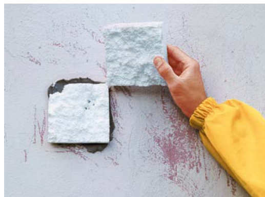
Teine katsemeetod ehk pull-off test
