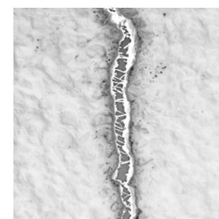
Szálakkal megtámogatott mikrorepedés
