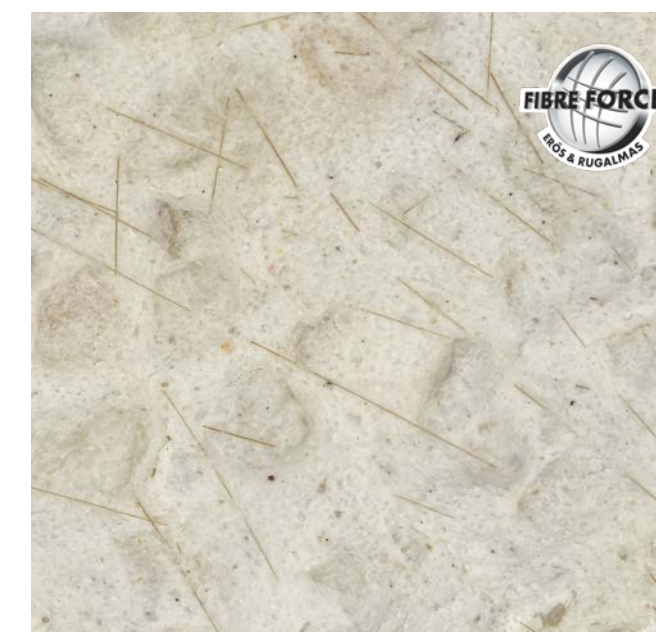
Mikroszkópos felvétel a vakolatban lévő szálakról
