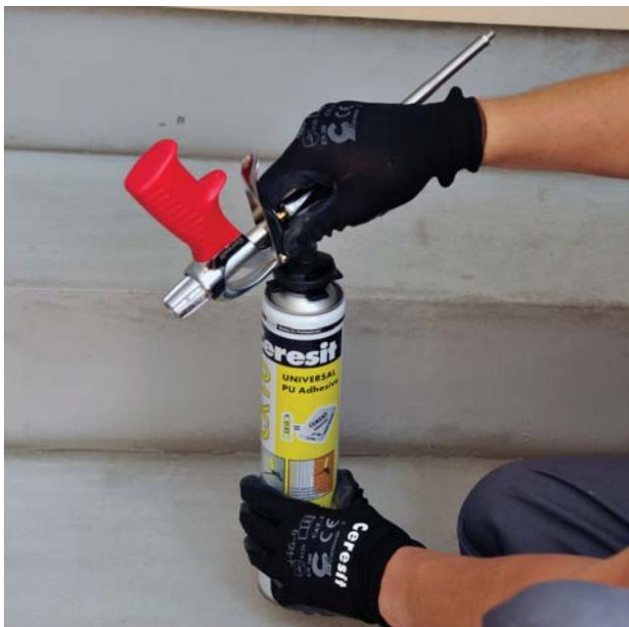
Püstoli paigaldamine ballooni külge
