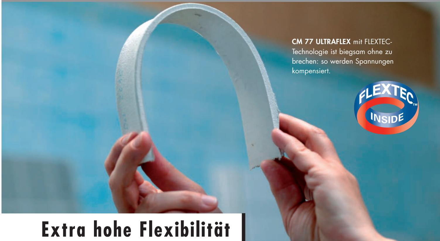
CM 77 ULTRAFLEX mit FLEXTEC-Technologie ist biegsam ohne zu brechen: so werden Spannungen kompensiert.
