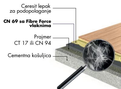
Ova relativno tanka samonivelišuća masa sa svojom novom poboljšanom formulacijom, čvršeće će se vezati za podlogu i moći će da izdrži naprezanje podloge i opterećenja.
