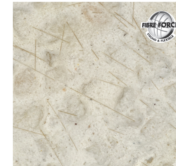
Mikroskopska vizualizacija vlaken znotraj ometa
