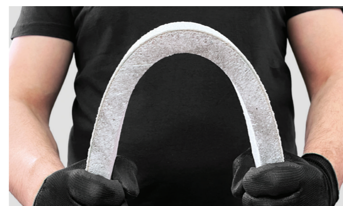
Vlaknima ojačani malter sa odličnom fleksibilnošću.
