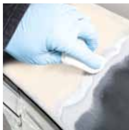
Applicazione di BONDERITE M-NT 1455 W solo sul metallo nudo. Mantenere la superficie bagnata per 2 min.
