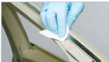
Pregătirea rapidă și corespunzătoare a suprafeței
