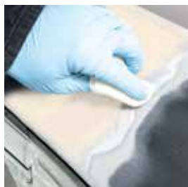
Aplicarea BONDERITE M-NT 1455 W doar pe metalul neacoperit. Mențineți umed timp de 2 min.
