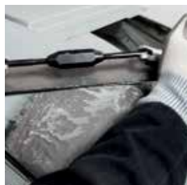
Șlefuire grosieră (cu pilă silix)
