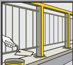
Žoga elementu montāža
