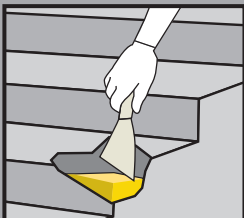
Betona elementu atjaunošana
